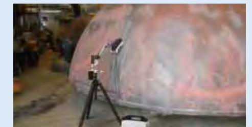
石油精製タンクの溶接、焼鈍効果の確認
